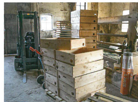
Sechs Tischler stellen im Nebenerwerb die Boxen für die Rattenhotels her. Sie werden anschließend bei einer Biogasanlage getrocknet, damit das Holz völlig frei von Feuchtigkeit ist und keinen Schimmel ansetzt.
